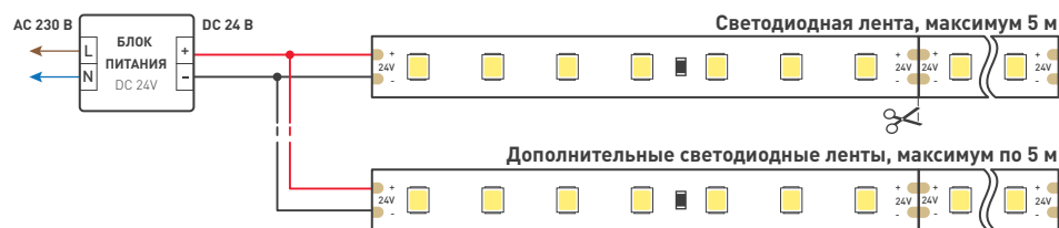
Рис.1. Подключение нескольких светодиодных лент с одной стороны
