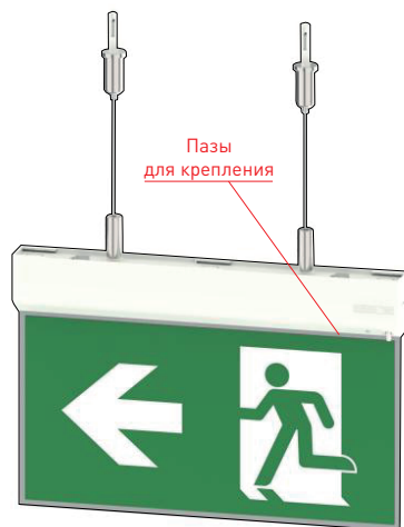
Рис. 1. Подвесной монтаж с использованием аксессуара арт. 045658
