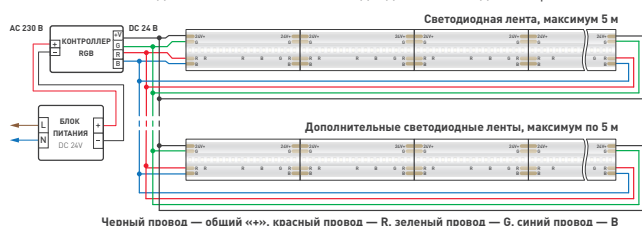
Схема 2. Подключение нескольких светодиодных лент с двух сторон
